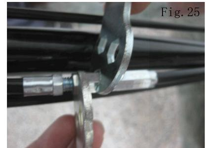
Vérifiez la force de la transmission ainsi que la course du levier. Une fois le bon réglage atteint, bloquez le dispositif de réglage en serrant le contre-écrou.
