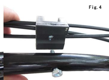
4. Monter le passe-câble sur le guidon inférieur à l'aide
